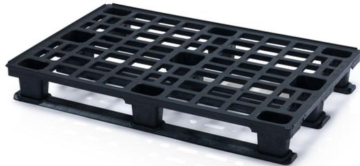
Die ESD-Paletten aus elektrisch leitfähigem Kunststoff wurden speziell für die sichere Lagerung und den Transport von empfindlichen elektrischen Bauteilen entwickelt. Sie verhindern zuverlässig die elektrostatische Entladung und leiten die vorhandene Entladung ab. Spez. Strömungswiderstand/Oberflächenwiderstand  $10^4 < 10^{10}$  Ohm.
