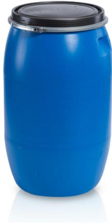
Kunststofffass mit Spannring, geeignet für den Transport und die Lagerung von Schüttgütern und Flüssigkeiten sowie von Gefahrstoffen. Der abnehmbare Deckel wird durch einen Metallring mit Hebelverschluss sicher verschlossen. Erfüllt auch anspruchsvolle Anforderungen für den Kontakt mit Lebensmitteln. Hergestellt aus HDPE. UN-Zertifikat gemäß ADR-Vorschriften.
